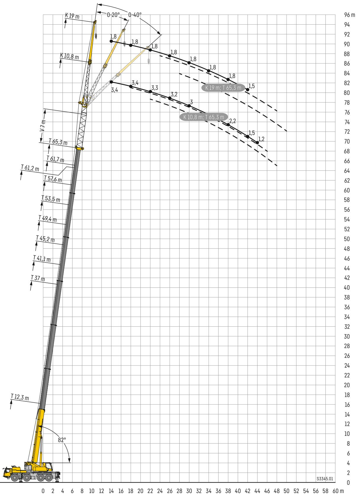
Lifting capacities · Forces de levage · Portate · Tablas de carga · Грузоподъемность
